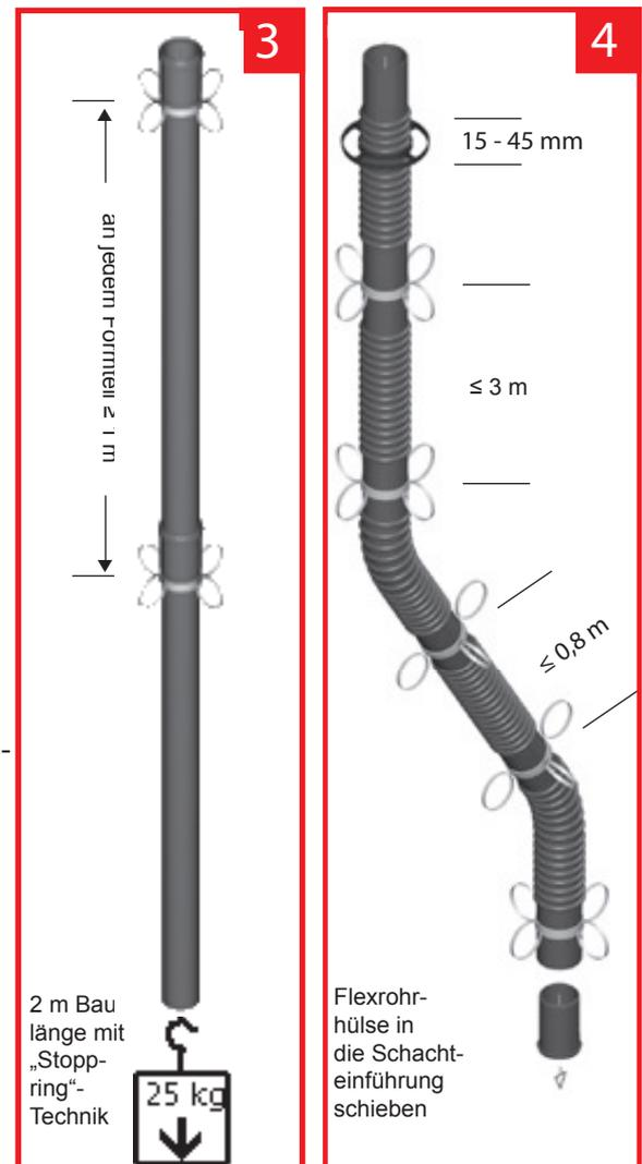
**5** Kontroll-Rohr und Kupplung für Rohr „flexibel“
