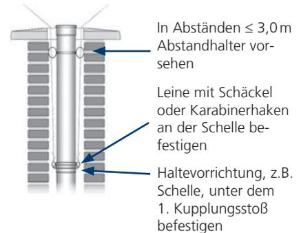
Abb. 11: Rohrelemente im Schacht ablassen
