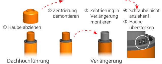
Abb. 4 Umbau der Dachhochführung und der Verlängerung
